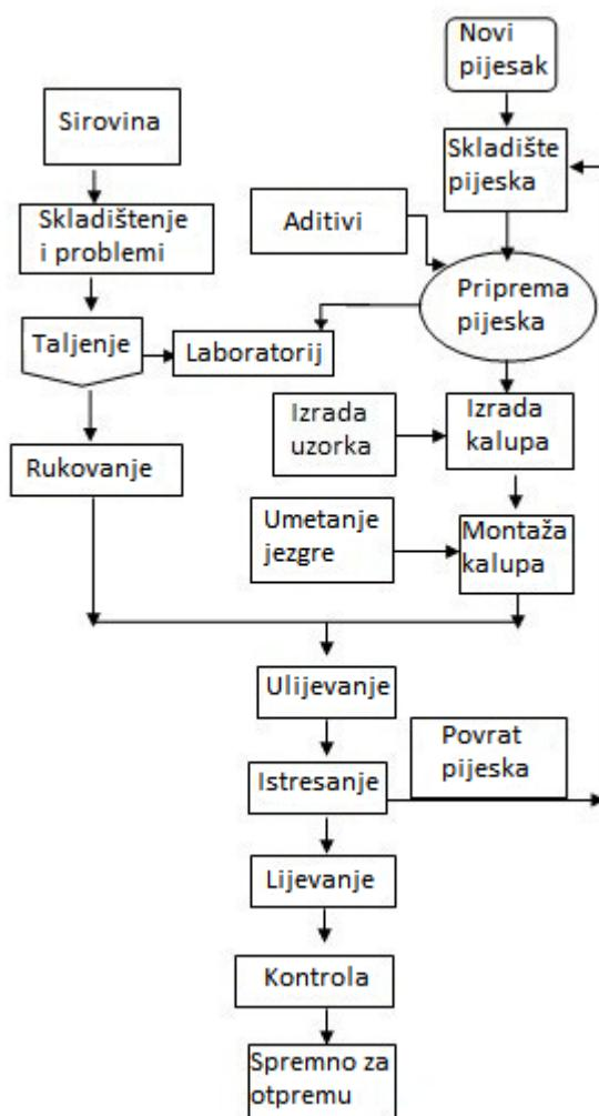
Slika 14. Dijagram toka procesa proizvodnje odljevaka [28]
