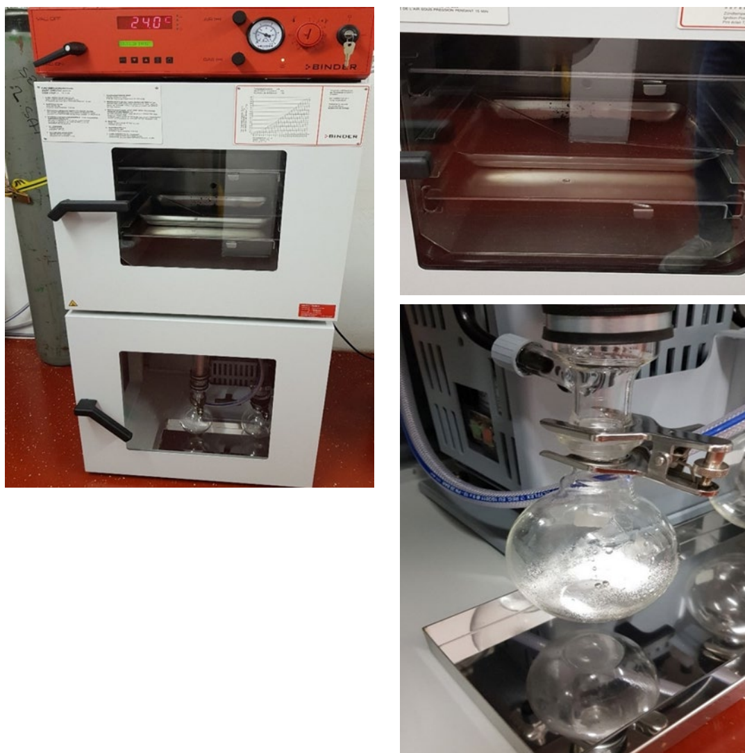
Slika 8.3. Prikaz sušenja praha uz izdvajanje heptana
