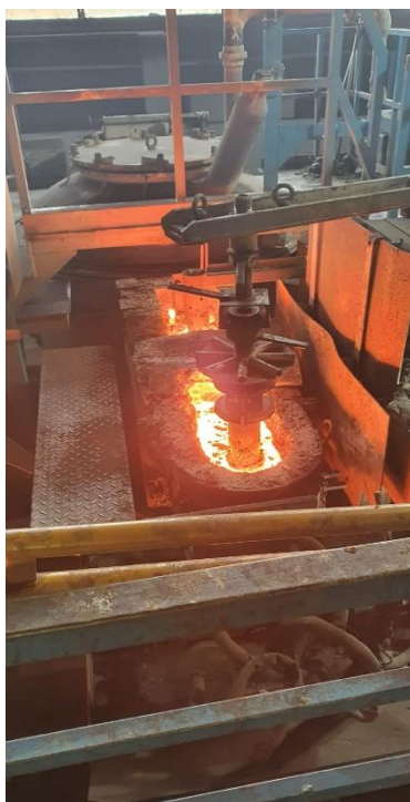
Slika 13. Kanalna peć za lijevanje (Junker)
