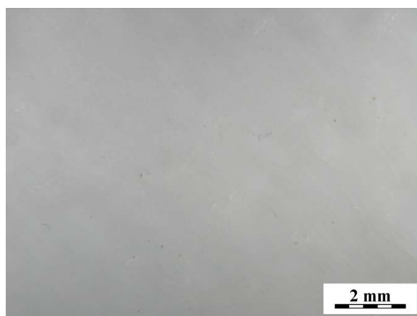
Slika 31. Mikrostruktura čistog TPS-a prije kompostiranja
