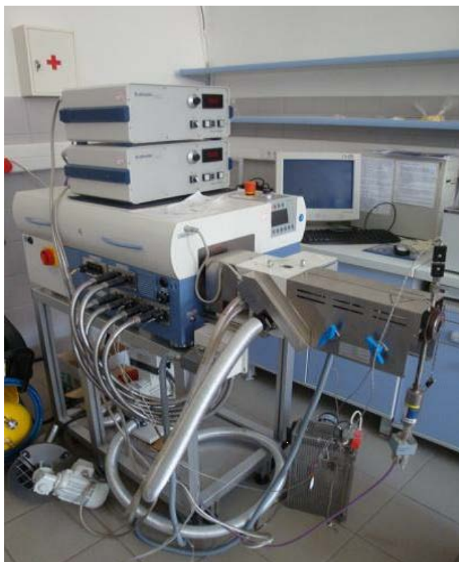
Slika 14. Laboratorijski jednapužni ekstruder Brabender 19/20 DN
