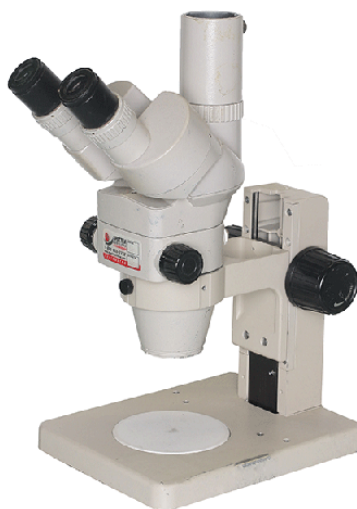
Slika 19. Svjetlosni mikroskop SMZ-2T Nikon, Japan [42]
