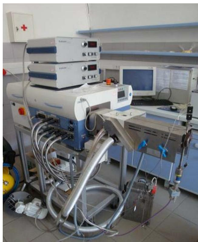
**Slika 14.** Laboratorijski jednopužni ekstruder Brabender 19/20 DN
