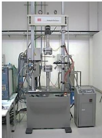
Slika 36. Uređaj za ispitivanje materijala MTS 810
