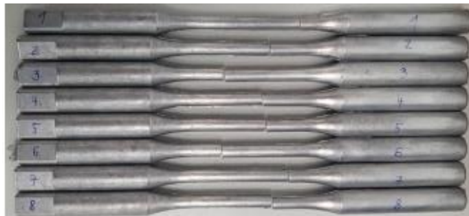
Slika 32. Epruvete nakon ispitivanja vlačne čvrstoće
