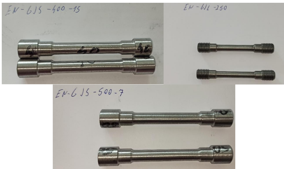
Slika 14. Uzorci za statički vlačni pokus prije ispitivanja
