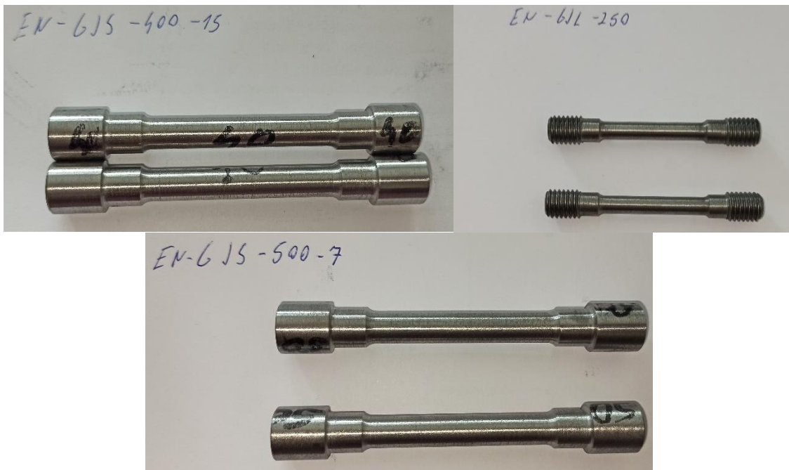
Slika 14. Uzorci za statički vlačni pokus prije ispitivanja
