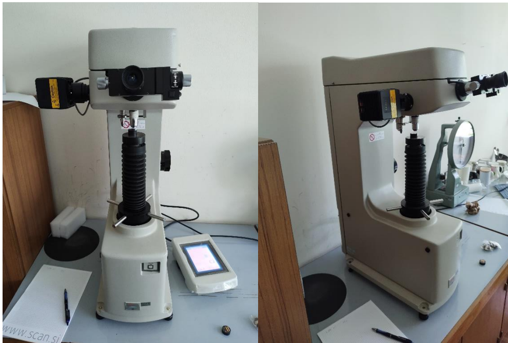
Slika 37. Mitutoyo Hardness Testing Machine HV, Model No. 810-165D, uređaj za mjerenje tvrdoće bakrene žice
