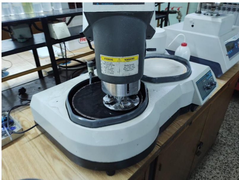
Slika 30. Buehler „Phoenix Beta“ uređaj za brušenje i poliranje uzoraka
