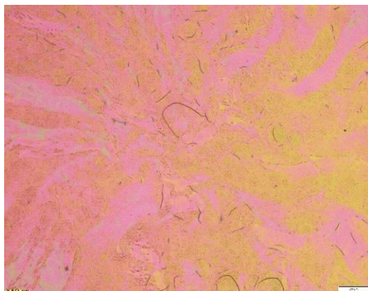
Slika 51. Mikrostruktura bakrene žice nakon redukcije 67,5% u središtu
