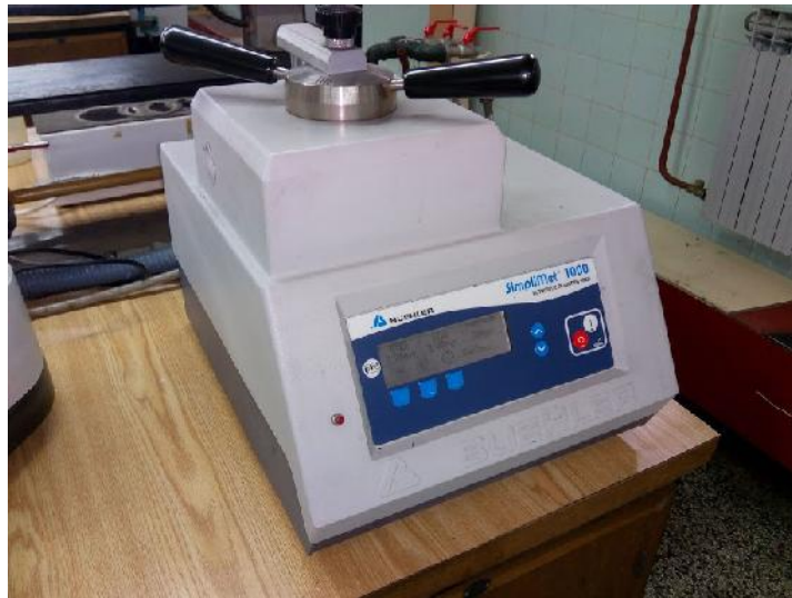
Slika 30. Ure aj za ulaganje uzorka u uglji nu masu postupkom vru eg prešanja, SimpliMet® 1000
