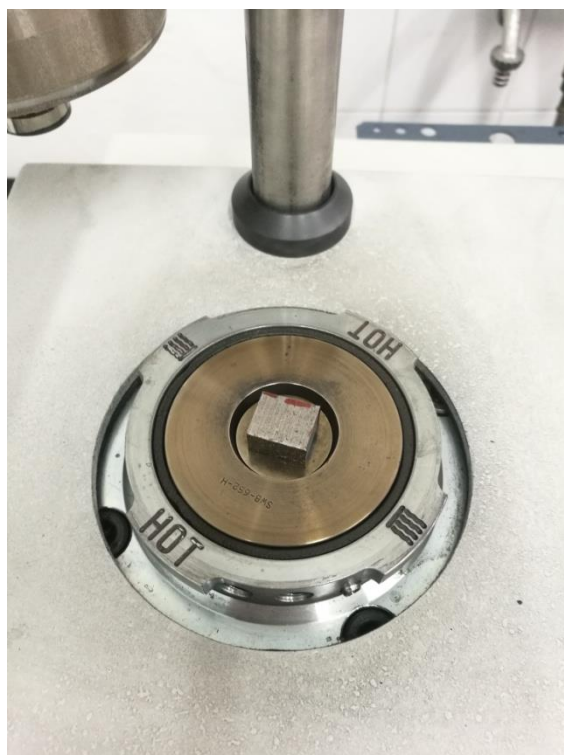
Slika 17. Uzorak u uređaju za ulaganje uzoraka u ugljičnu masu postupkom vrućeg prešanja
