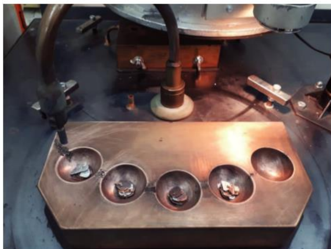
Slika 31. Bakreni kalup prije postupka taljenja s postavljenim čistim metalima
