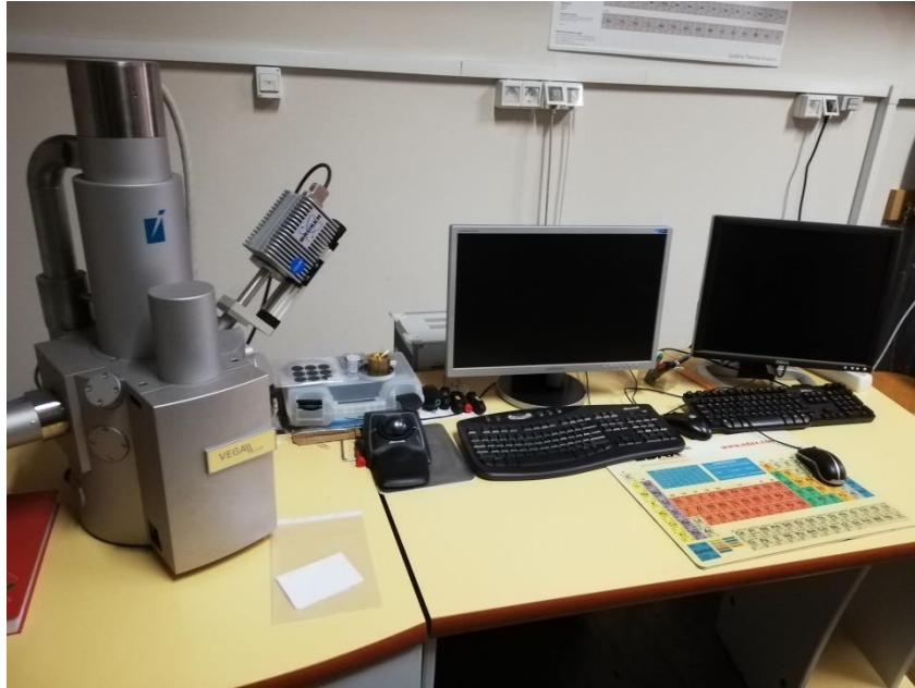
Slika 39. Pretražni elektronski mikroskop Tescan VEGA 5136 MM
