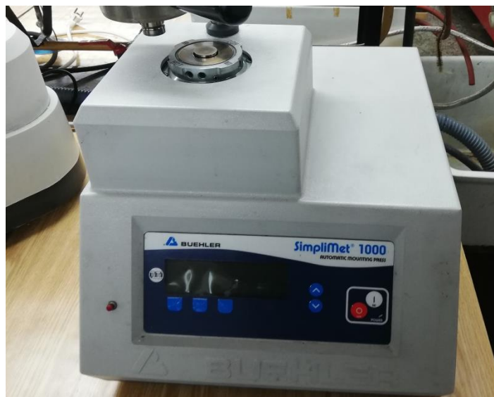
Slika 36. Uređaj Buehler Simplimet 1000 za vruće prešanje uzoraka u vodljivu masu
