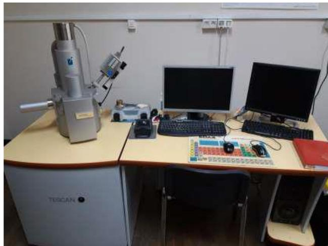
Slika 19. Scanning elektronski mikroskop Tescan Vega TS 5136 MM
