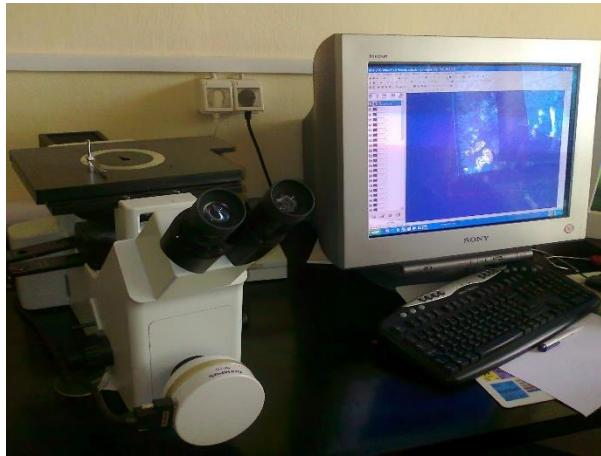
Slika 18. Svjetlosni mikroskop Olympus GX51 s digitalnom kamerom
