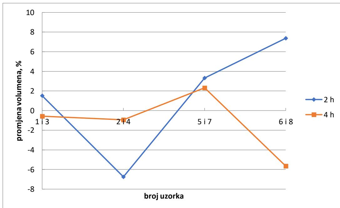
Slika 31. Ovisnost promjene volumena o vremenu sinteriranja
