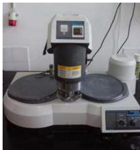
Slika 16. Uređaj za brušenje i poliranje
