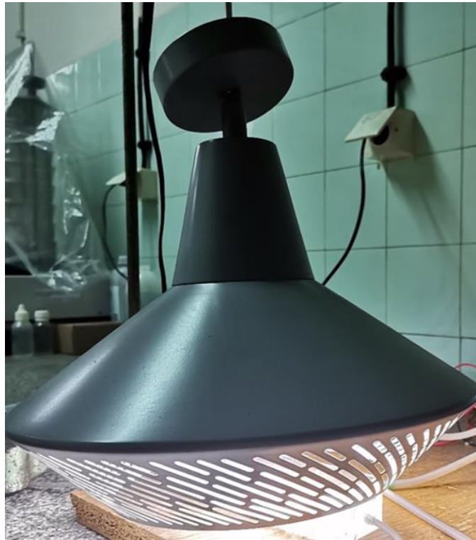
Slika 14. Prikaz glavnog dijela fotoreaktora, UV lampa
