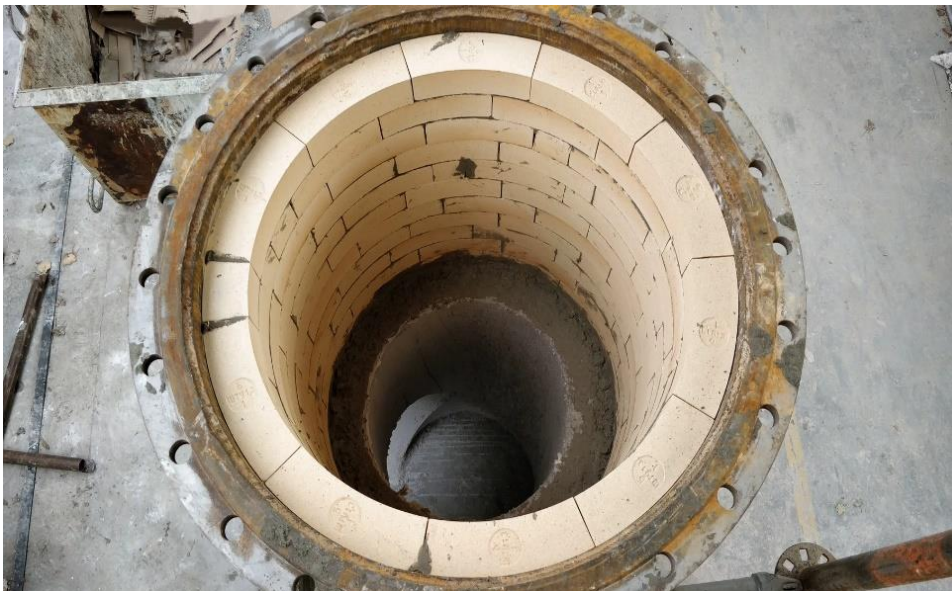
Slika 7. Primjer ozida peći [13]
