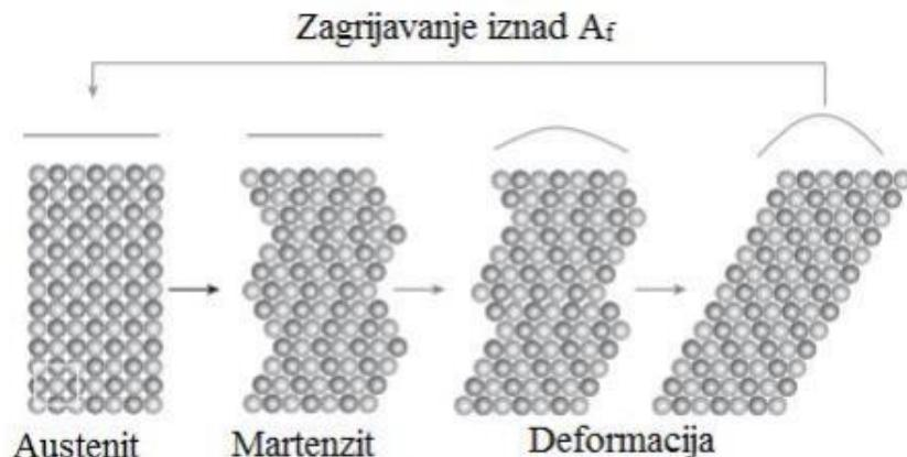
Slika 3. Mehanizam efekta prisjetljivosti oblika [12]
