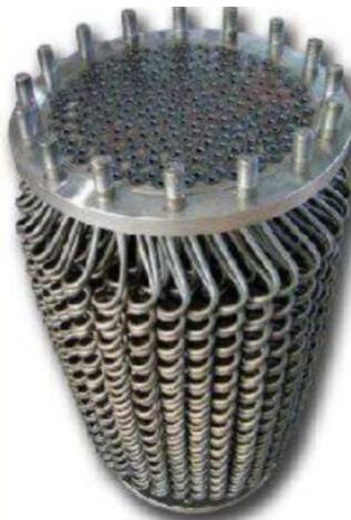
Slika 2. Spiralni izmjenjivač topline [6]
