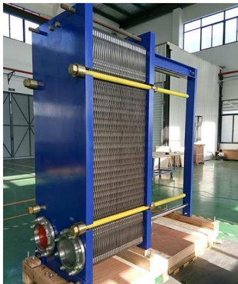
Slika 3. Pločasti izmjenjivač topline [7]
