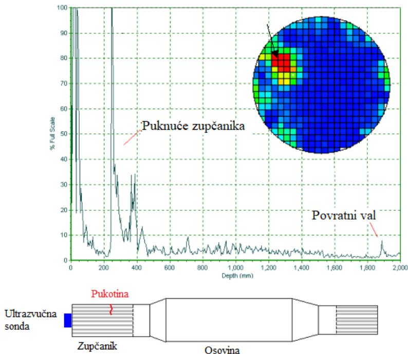
Slika 11. Pukotina na vratilu uočena ultrazvučnim ispitivanjem [26]
