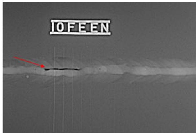
Slika 9. Oštećenje uočeno radiografskim ispitivanjem [24]
