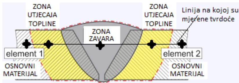
Slika 16. Zone zavarenog spoja i mjesta mjerena tvrdoće
