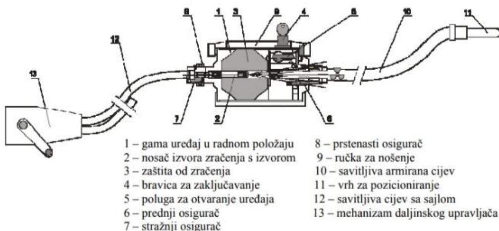
Slika 10. Shematski prikaz gama uređaja za snimanje [15]
