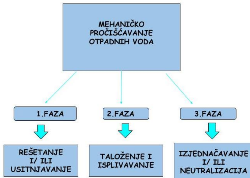
Slika 6. Faze primarnog ili mehaničkog pročišćavanja otpadnih voda
