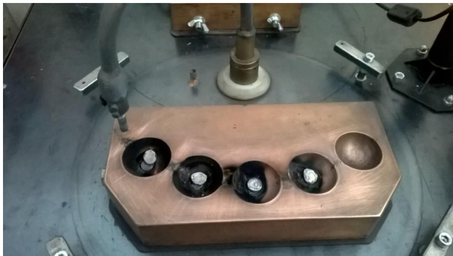
Slika 15. Taljenje uzoraka električnim lukom u bakrenom kalupu
