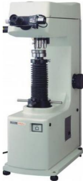
Slika 14. Fotografija uređaja za ispitivanje tvrdoće po Vickersu
