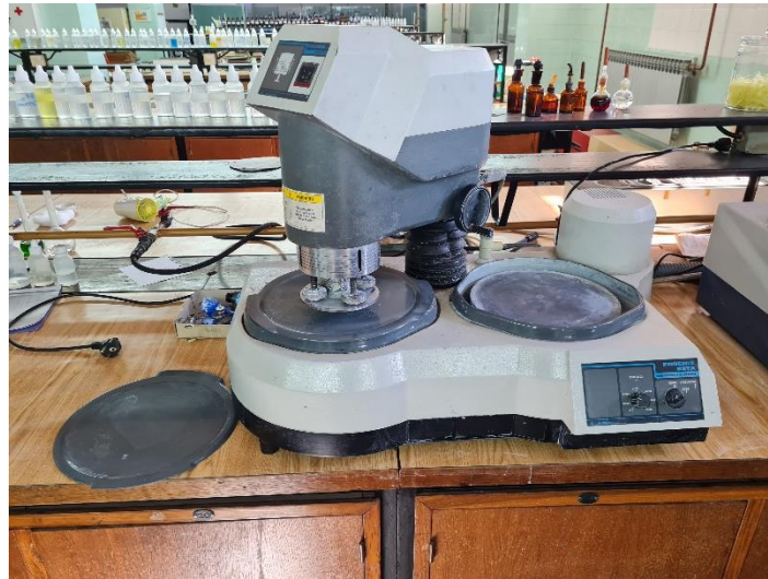
Slika 12. Fotografija uređaja za brušenje i poliranje Phoenix Beta Buehler
