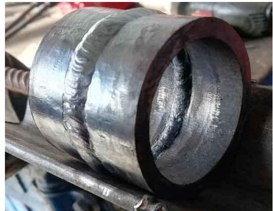
Slika 10. Fotografija korjena zavara a) i konačnog zavarenog spoja b)
