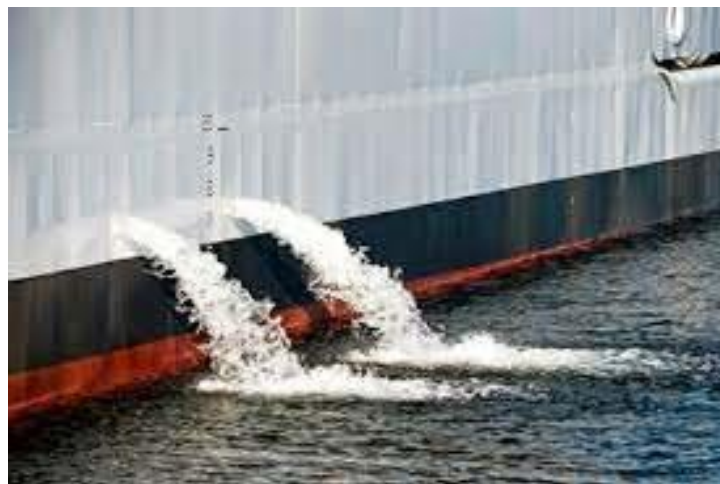
Slika 8. Ispuštanje balastnih voda [23]
