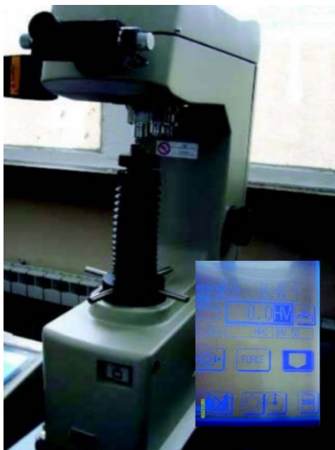
Slika 24. Vickersov tvrdomjer za mjerenje SMA legura [32]
