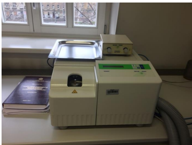
Slika 31. Diferencijalni pretražni kalorimetar, MDSC Mettler-Toledo 822e
