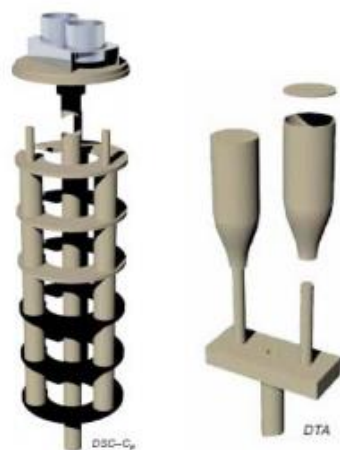
Slika 32. Nosač za DSC analizu [31]
