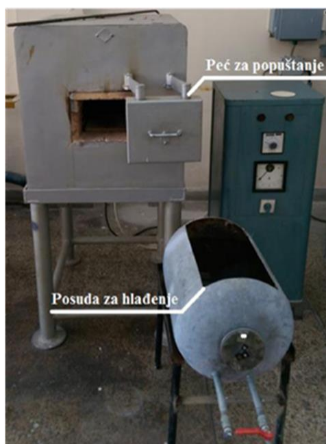
Slika 25. Elektrootporna komorna peć za popuštanje [20]
