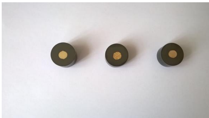
Slika 28. Nagriženi uzorci Cu-SMA legura
