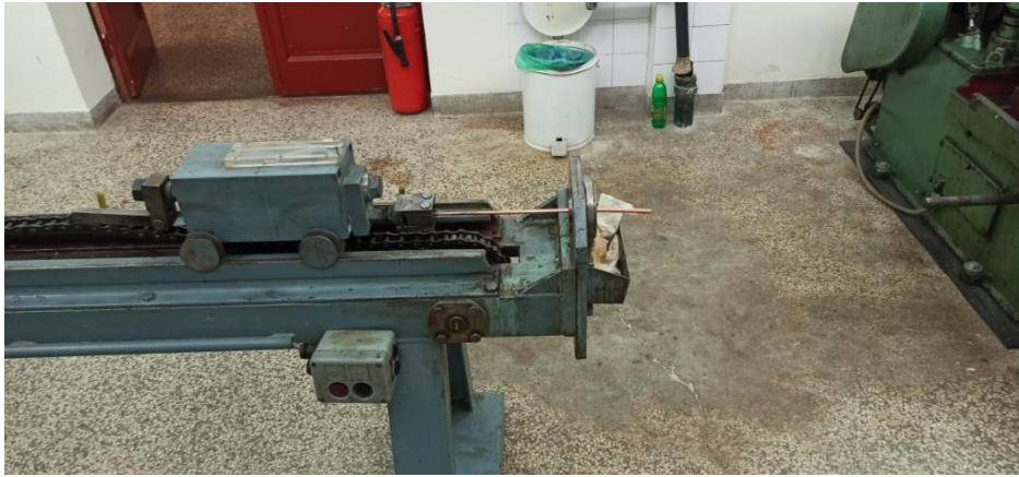
Slika 11. Provlačenje žice na vlačnoj klupi
