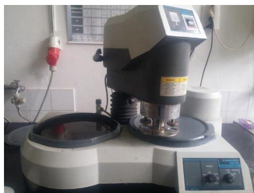
**Slika 15.** Uređaj za brušenje i poliranje Vektor LC Buehler Phoenix
