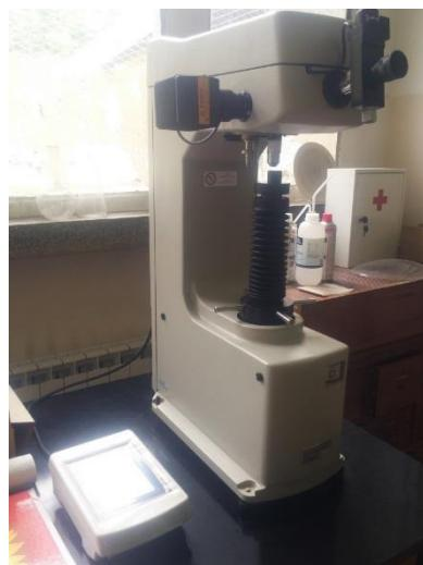
Slika 17. Uređaj za mjerjenje tvrdoće metodom po Vickersu
