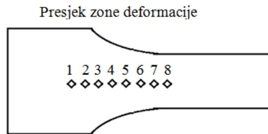
**Slika 28.** Pozicije mjerena tvrdoće duž zone deformacije
