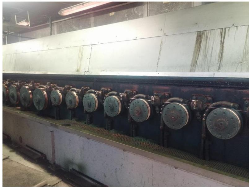
**Slika 7.** Stroj za provlačenje
