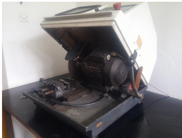
Slika 12. Uređaj za rezanje uzorka
