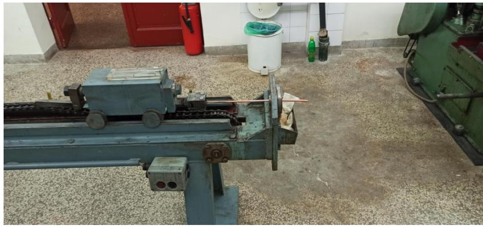
**Slika 11.** Provlačenje žice na vlačnoj klupi
