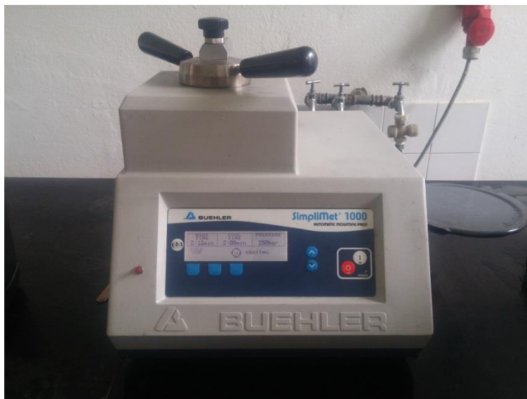
Slika 13. Uređaj za ulaganje uzoraka u vodljivu masu
