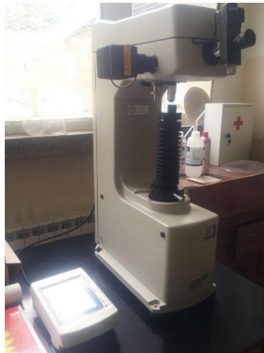
Slika 17. Uređaj za mjerenje tvrdoće metodom po Vickersu
