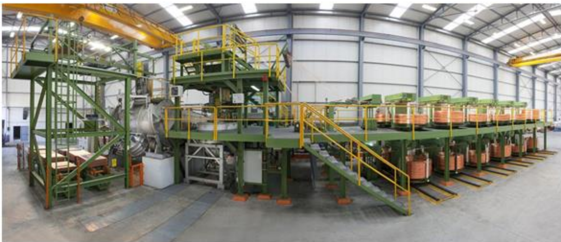
Slika 3. Proizvodna linija UPCAST postupka [5]
