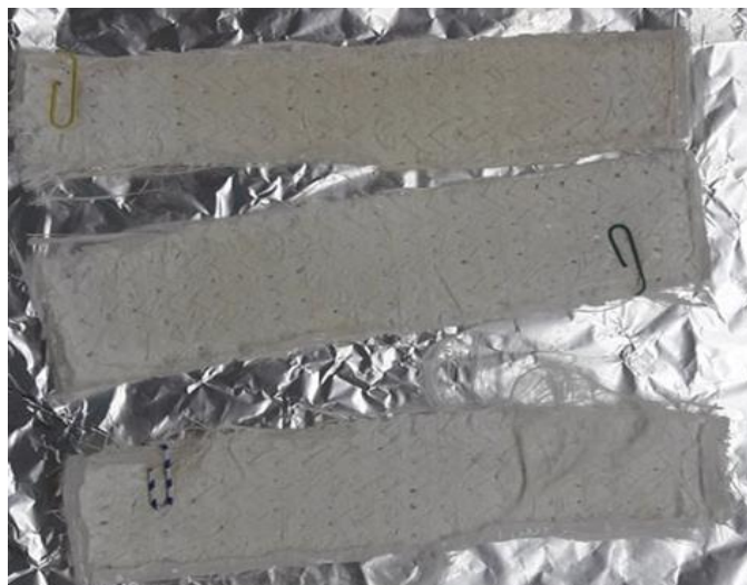
Slika 18. Staklene mrežice s \text{TiO}_2 slojem
