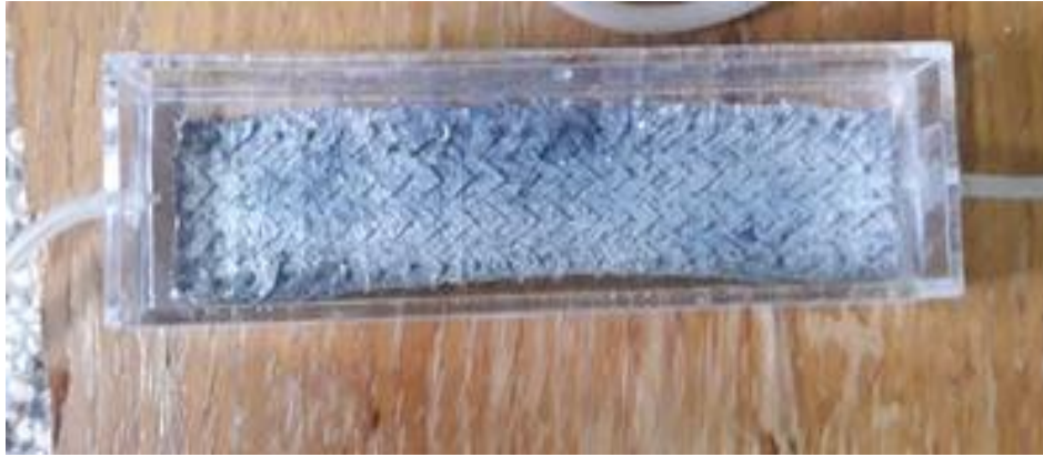
Slika 16. Reaktor za ispitivanje fotokatalitičke aktivnosti
