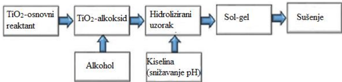
Slika 13. TiO 2 sol-gel metoda [34]
