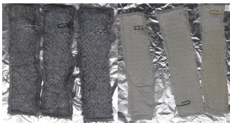
Slika 22. Simulacija starenja pripremljenih fotokatalizatora; a) starenje u vodi, b) starenje na zraku
