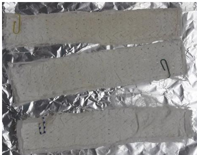
Slika 18. Staklene mrežice s \text{TiO}_2 slojem
