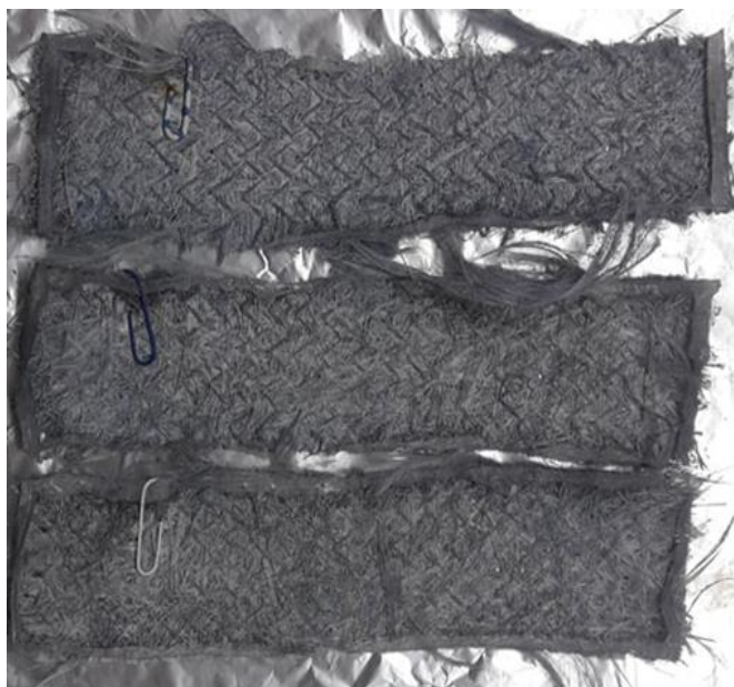
Slika 19. Staklene mrežice s 10 % ugljikovih nanocijevi
