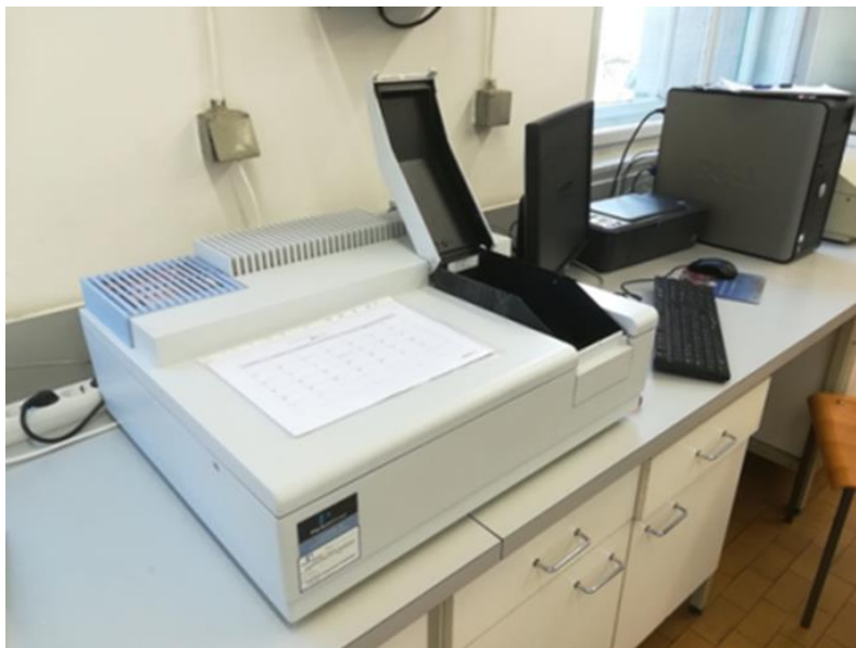
Slika 13. UV/VIS spektrofotometar u laboratoriju na FKIT-u.
