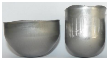
Slika 18. Pojava ušičavosti kod dubokog izvlačenja čelika [35]
