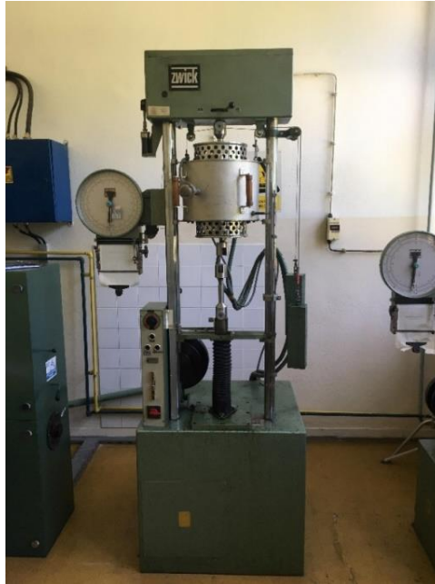
Slika 24. Kidalica Zwick 50 kN
