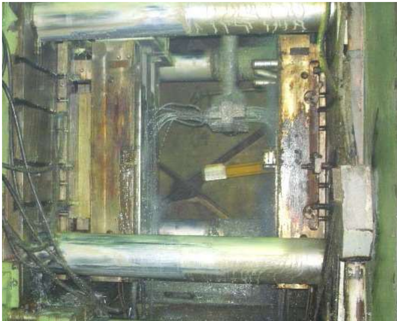
Slika 9. Šprica za nanošenje premaza "Acheson mod ECO 2B4/2" [3]
