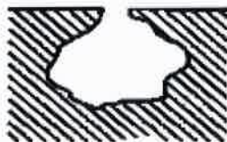
d) PODPOVRŠINSKA KOROZIJA
