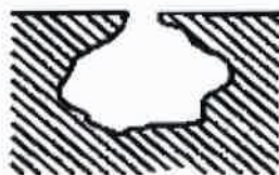
d) PODPOVRŠINSKA KOROZIJA
