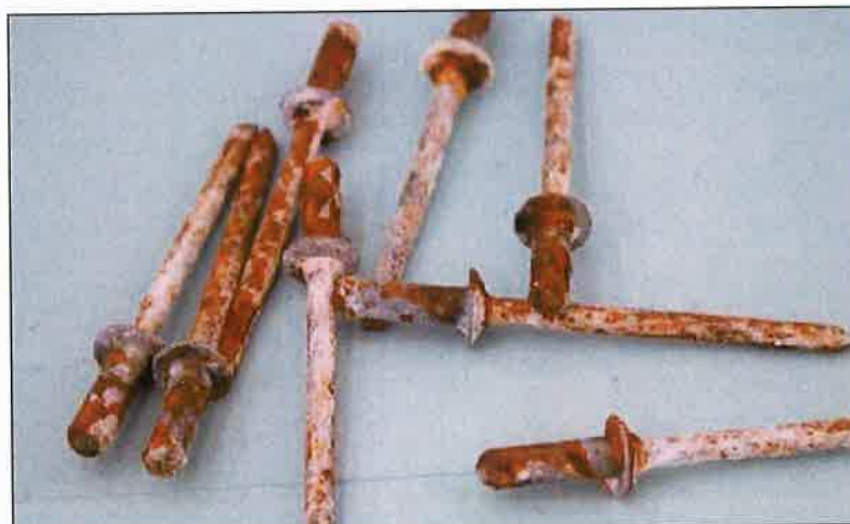
Slika 2. Kemijska korozija blok zakovica i zakivnih matica [6]
