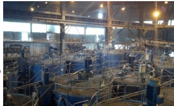
Slika 5. Proces flotacije: a) shematski prikaz postupka flotacije [6] b) flotacijske ćelije (Veliki Krivelj)
