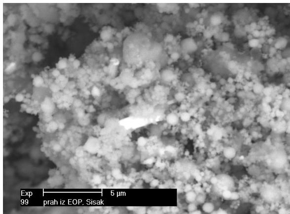
Slika 3 – Elektronski mikrosnimak uzorka elektropećne prašine (uvećanje  $6400\times$ )<sup>22</sup>
