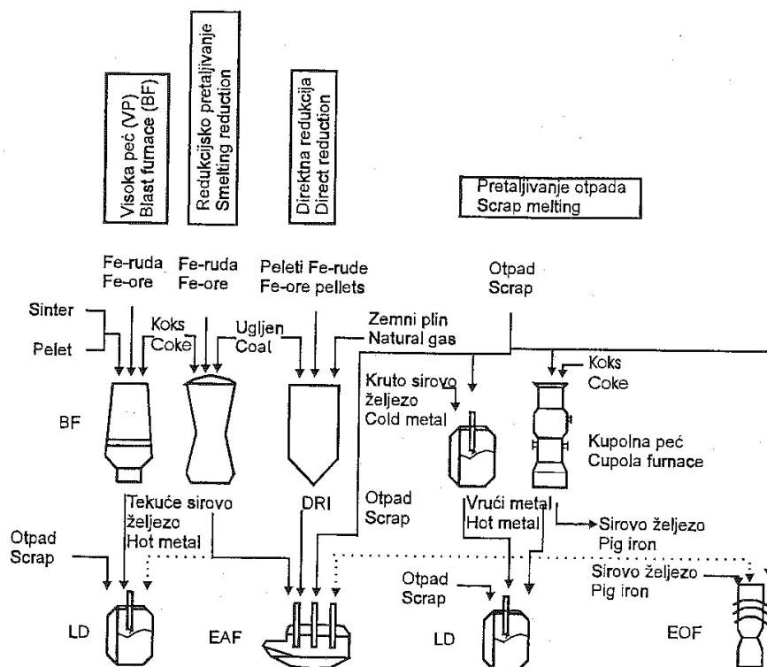
Slika 1 – Načini i kombinacije proizvodnje čelika<sup>5</sup>
