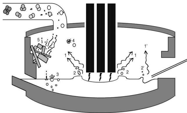
Slika 2 – Prikaz mesta nastajanja prašine u elektrolučnoj peći<sup>17</sup>
