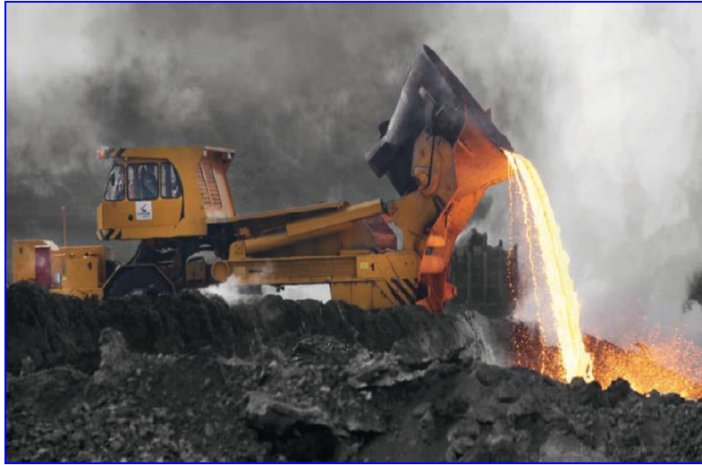
Slika 11. Odvoženje troske do mjesta za hlađenje – kamionima [26]
