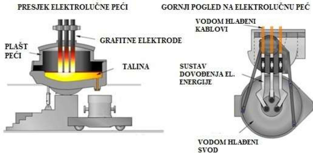
Slika 7. Presjek i gornji pogled elektrolučne peći [26]
