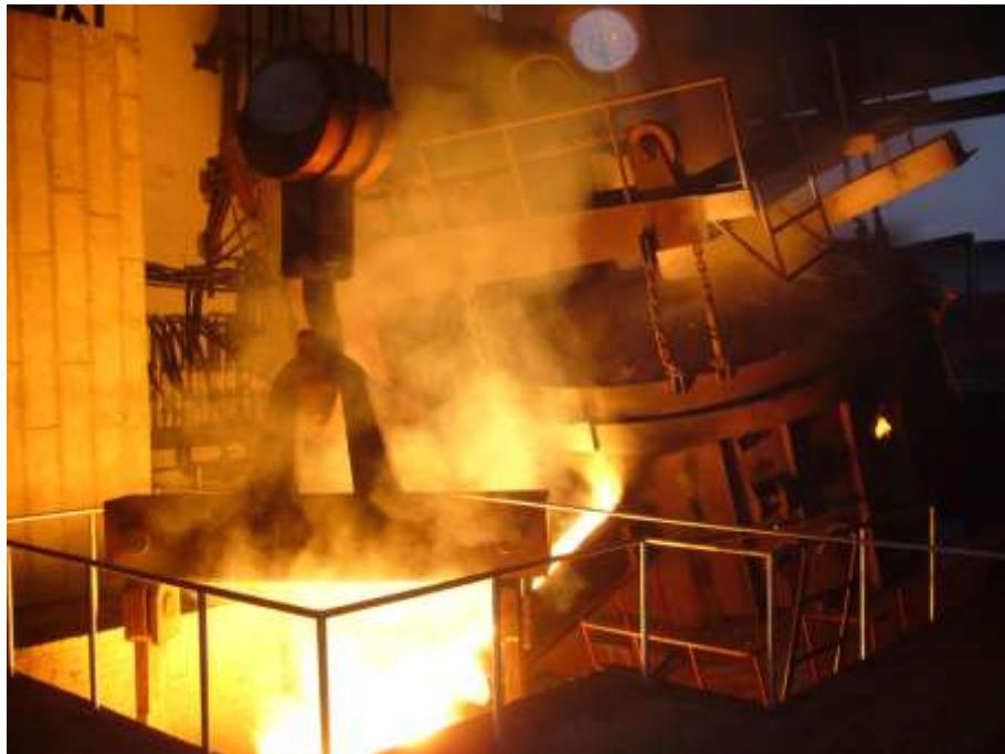
Slika 8. Izljijevanje čelika iz elektrolučne peći [28]
