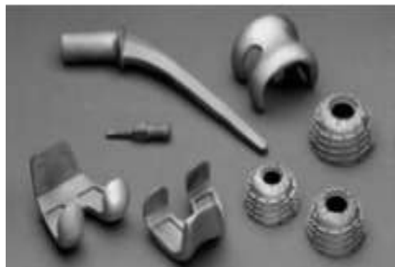
Slika 6. Ortopedski implantati - dijelovi umjetnog kuka izrađeni od legure titana [22]
