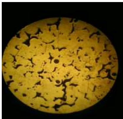
Slika 21. Polirani uzorak s porama
