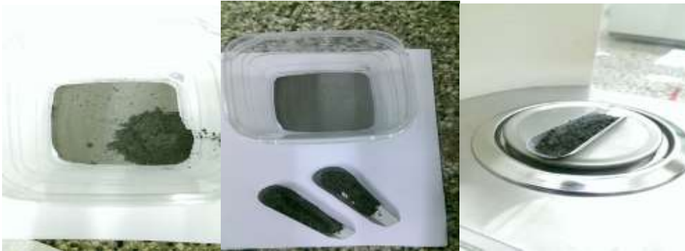
Slika 12. Vaganje polaznih prahova
