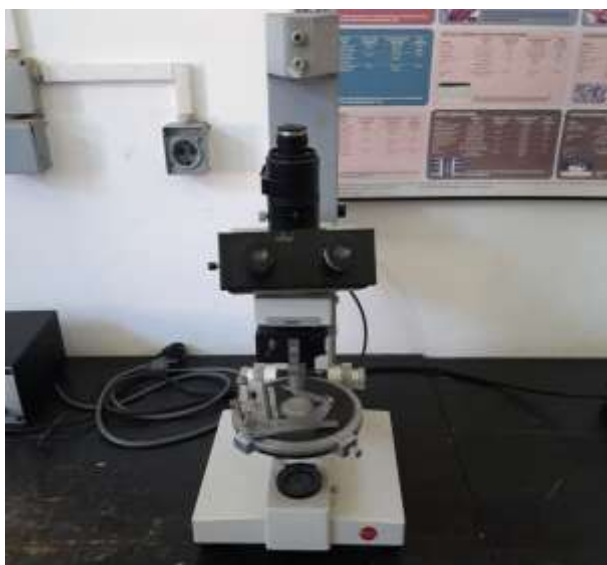
Slika 20. Metalografski svjetlosni mikroskop Leica Ortholux
