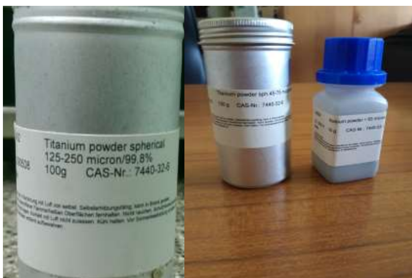
Slika 11. Polazni prahovi titana i niobija
