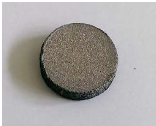
Slika 16. Otpresak Ti 80 Nb 20 legure
