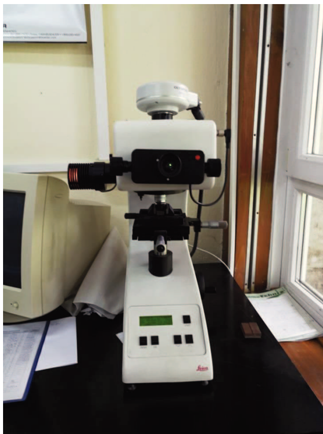
Slika 32. Fotografija uređaja za mjerenje tvrdoće Leica
