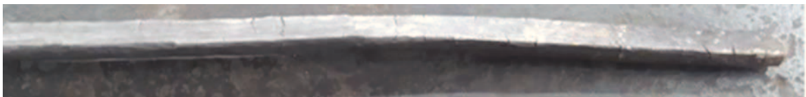
Slika 23. Fotografija šipke Cu-Al-Mn legure s prisjetljivosti oblika nakon prve provlake vrućeg valjanja i kovanja
