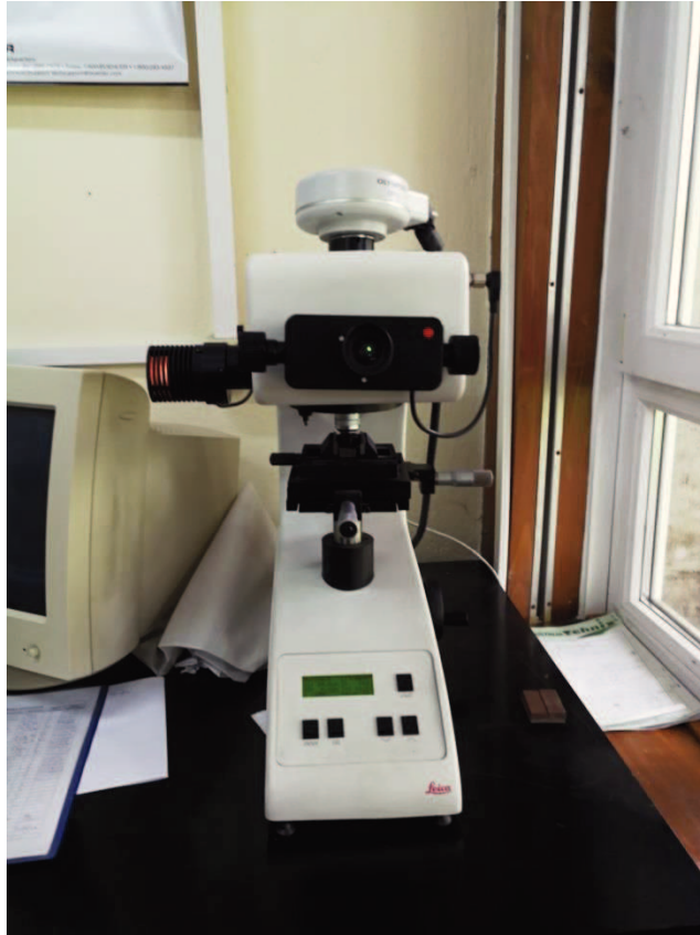
Slika 32. Fotografija uređaja za mjerenje tvrdoće Leica
