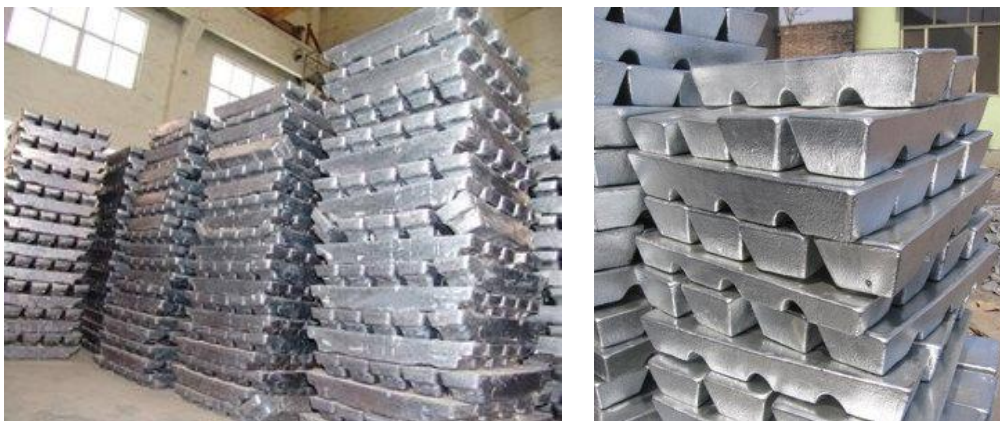
Slika 15. Rafinirano olovo - ingoti [45, 46]
