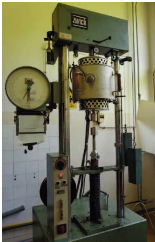
Slika 54. Kidalica Zwick 50 kN
