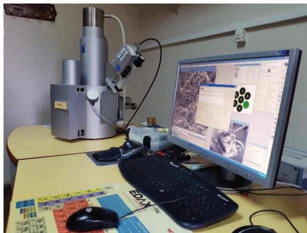
Slika 51. Pretražni elektronski mikroskop Tescan VEGA TS 5136 MM
