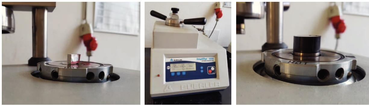
Slika 46. Priprema uzorka vrućim ulaganjem: (a) postavljanje uzorka u komoru, (b) uređaj za vruće ulaganje, (c) uloženi uzorak
