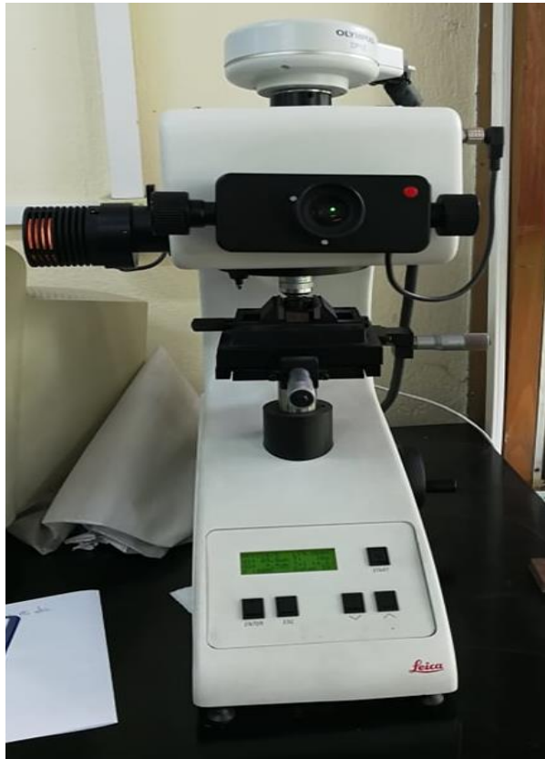
Slika 19. Fotografija mikrotvrdomjera Leica VHMT korištenog za ispitivanje mikrotvrdoće
