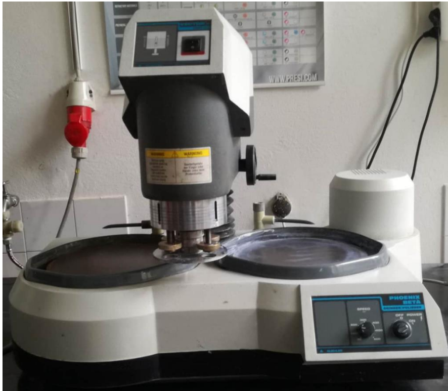
Slika 14. Fotografija uređaja Phoenix Beta proizvođača Buehler za brušenje i poliranje uzoraka
