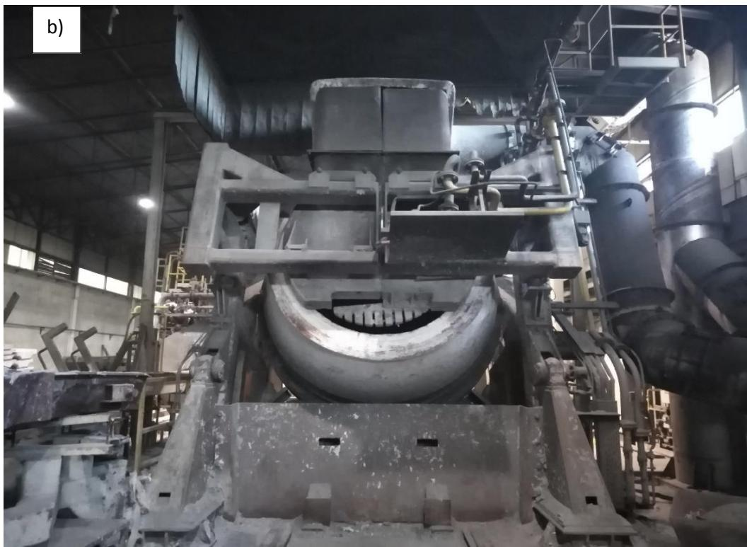
Slika 31. Rotacijska nagibna peć u tvornici CIAL d.o.o.: a) u radu, b) u hladnom pogonu
