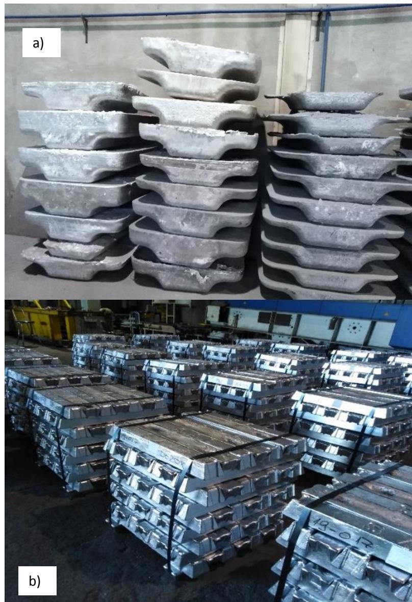
*Slika 33. Aluminijski: a) blokovi i b) ingoti*
