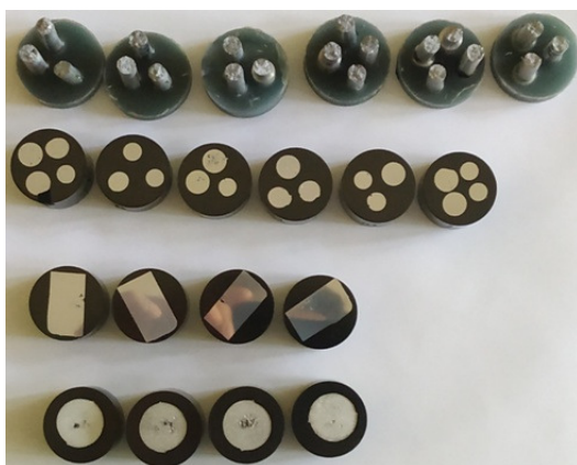
Slika 54. Uzorci za metalografsku analizu
