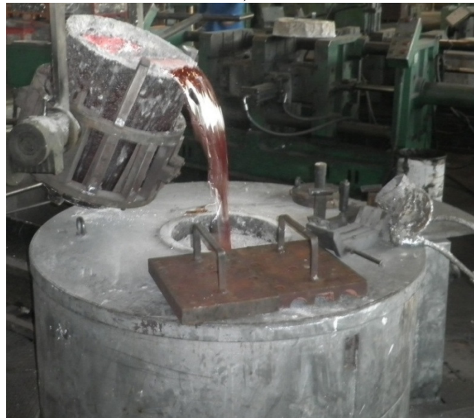
Slika 44. Peć za: a) taljenje s FDU-uređajem, b) održavanje temperature
