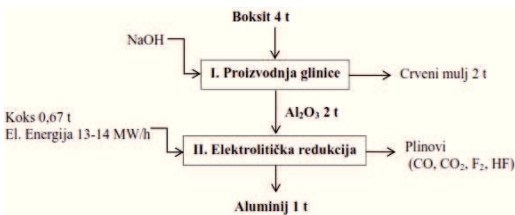
Slika 6. Shematski prikaz proizvodnje primarnog aluminija [23]
