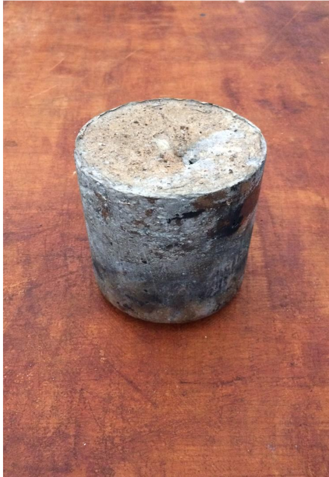
Slika 13. Fotografija ingota ispitivane CuAlMn legure
