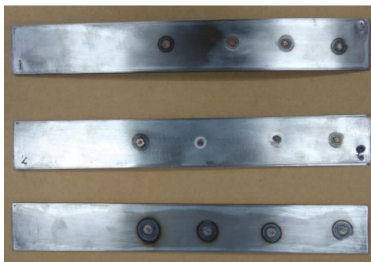
Slika 19. Zavareni uzorci iz limova
