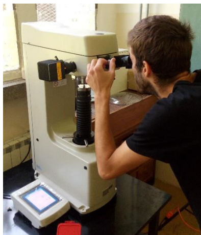
Slika 23. Ispitivanje makro-tvrdoće u području zavora
