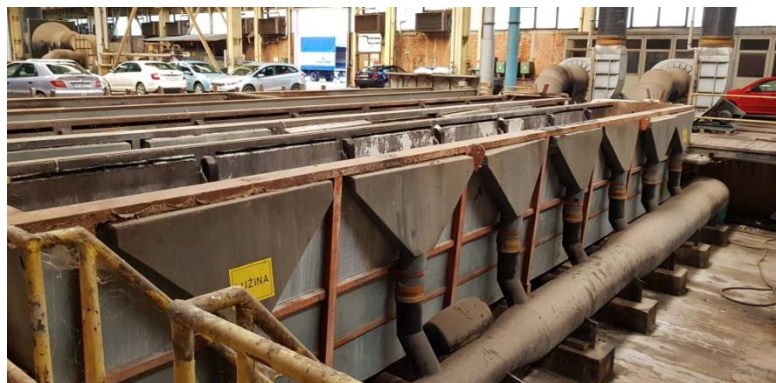
Slika 15. Kade za luženje cijevi u kiselinama
