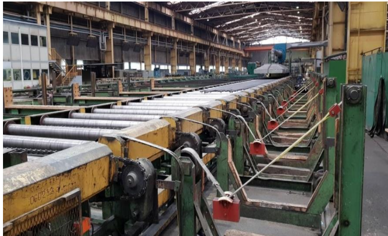
Slika 22. Cijevi nakon žarenja u peći
