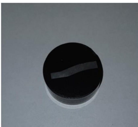
Slika 35. Uzorak spreman za metalograsku analizu
