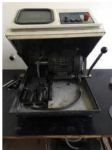
Slika 28. Buehler ABRASIMET 2 pila za rezanje
