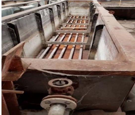
Slika 16. Kada s grijačima za ispiranje cijevi u zagrijanoj vodi
