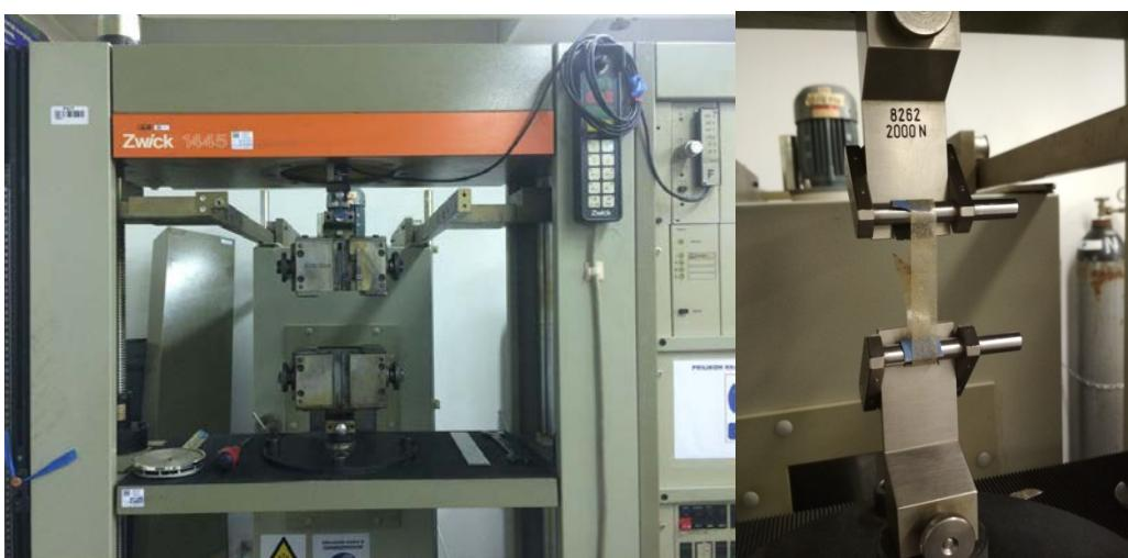
Slika 33. Mehanička kidalica Zwick 1445
