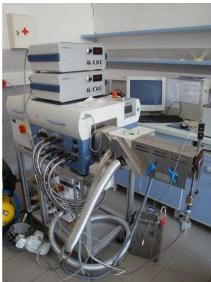
Slika 27. Laboratorijski jednopužni ekstruder Brabender 19/20 DN
