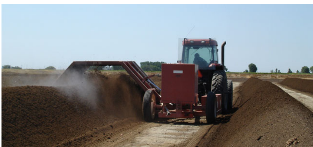
Slika 19. Otvoreni sustav za kompostiranje [44]
