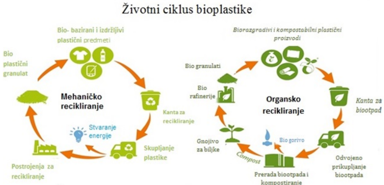
Slika 16. Prikaz životnog ciklusa biorazgradivih proizvoda; mehaničko recikliranje (lijevo) i organsko recikliranje (desno) [35]
