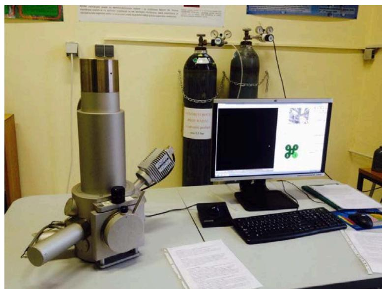
Slika 31. Elektronski pretražni mikroskop (SEM)
