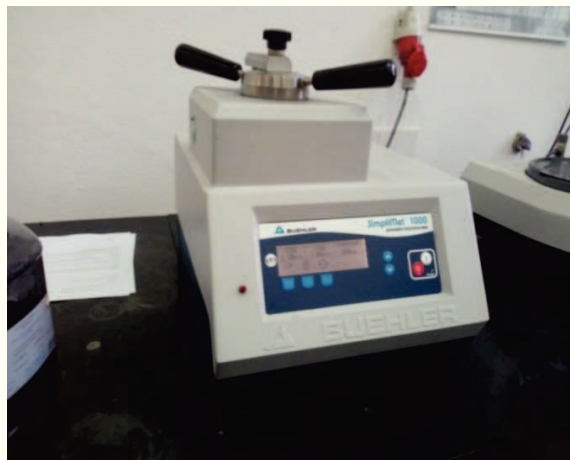
Slika 36. Uređaj za vruće izostatsko prešanje; "BUEHLER SimpliMet 1000".
