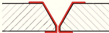
Slika 26. Označeni dijelovi sučeonog spoja koji moraju biti čisti [27].
