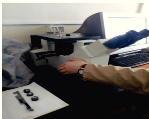
Slika 40. Invertni metalografski mikroskop Olympus GX51 s digitalnom kamerom DP70.
