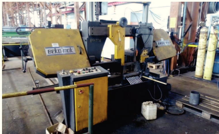
Slika 30. BEKA-MAK BMSO450 tračna pila.
