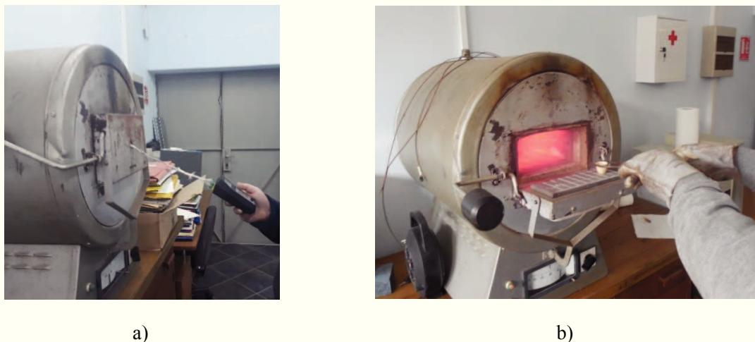
Slika 16. Provođenje eksperimenta: a) kontrola temperature zagrijavanja digitalnim termometrom, b) vađenje jednog od uzoraka iz peći
