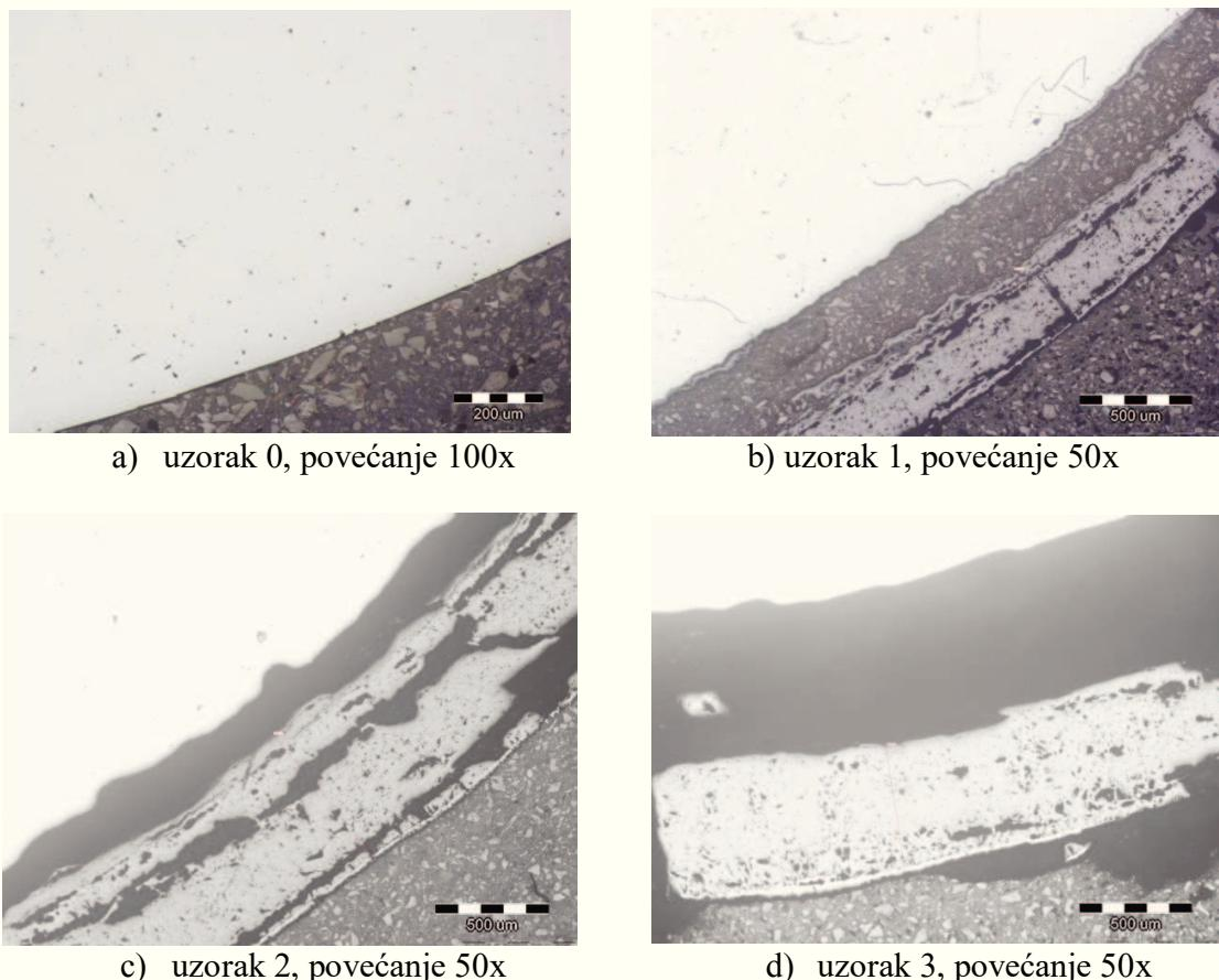
Slika 24. Metalografske snimke površinskog sloja analiziranih uzoraka
