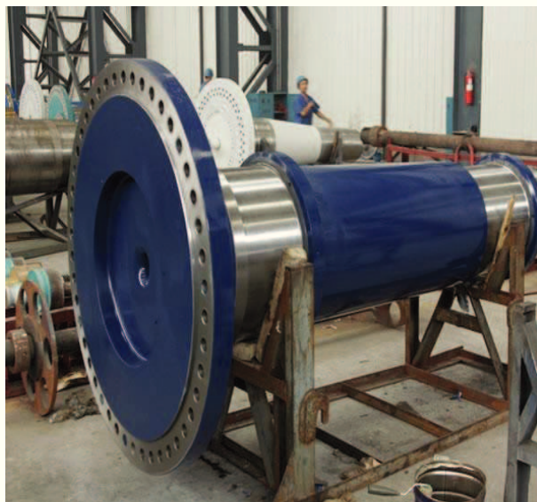
Slika 4. Glavna osovina vjetroagregata izrađenog iz čelika za poboljšavanje [7]
