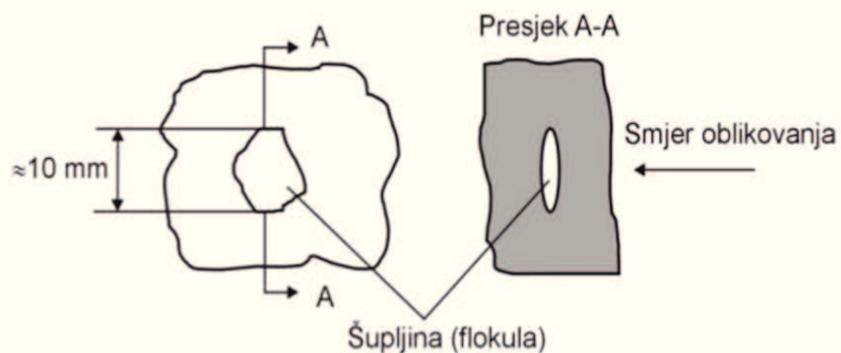
Slika 8. Shematski prikaz flokule nastale zbog djelovanja vodika [3]
