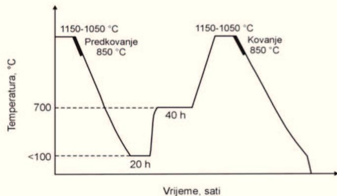
Slika 9. Shematski prikaz dijagrama žarenja za sprječavanje pojave flokula [3]
