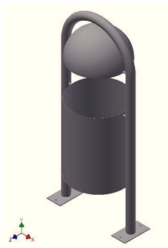
Slika 12. Konstrukcija samostojećeg okruglog koša
