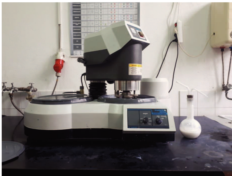
Slika 36. Fotografija uređaja za brušenje i poliranje "Buehler Phoenix Beta"
