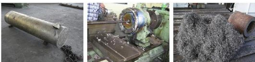
a) Ti-ingot      b) rezanje i oblikovanje ingota      c) nereciklabilna strugotina
