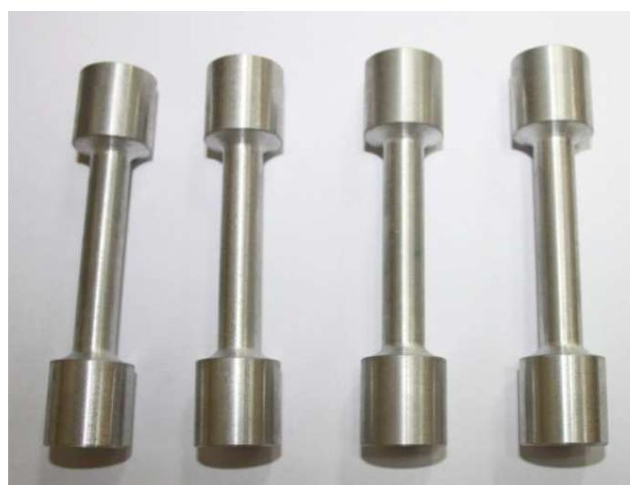
Slika 32. Ispitni uzorci za vlačna ispitivanja.
