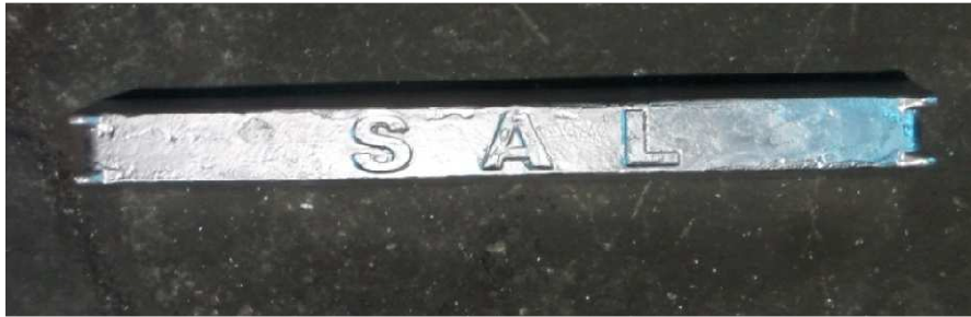
Slika 22. Odljevak od AlSi9Cu3(Fe) legure.
