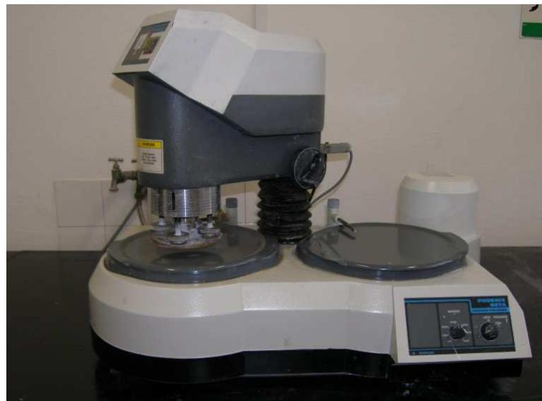
Slika 29. Uredaj za brušenje i poliranje uzorka.
