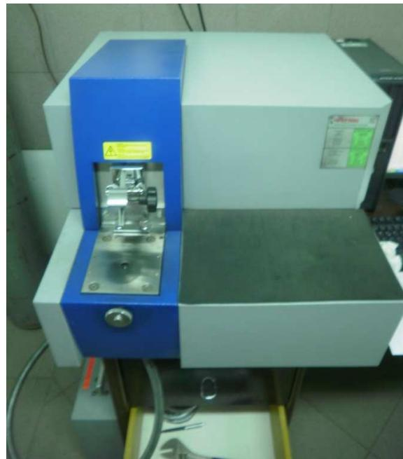
Slika 26. Spektrometar tip SPECTRO MAXx.
