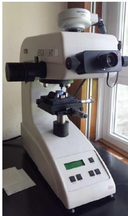
Slika 30. Mikrotvrdomjer Leica VMHT.
