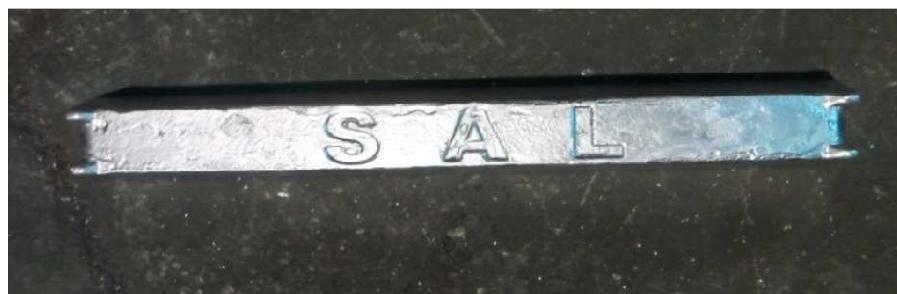
Slika 22. Odljevak od AlSi9Cu3(Fe) legure.
