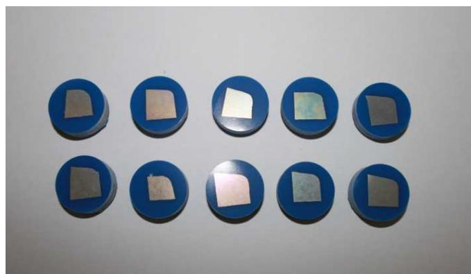
Slika 28. Uzorci za metalografska ispitivanja
