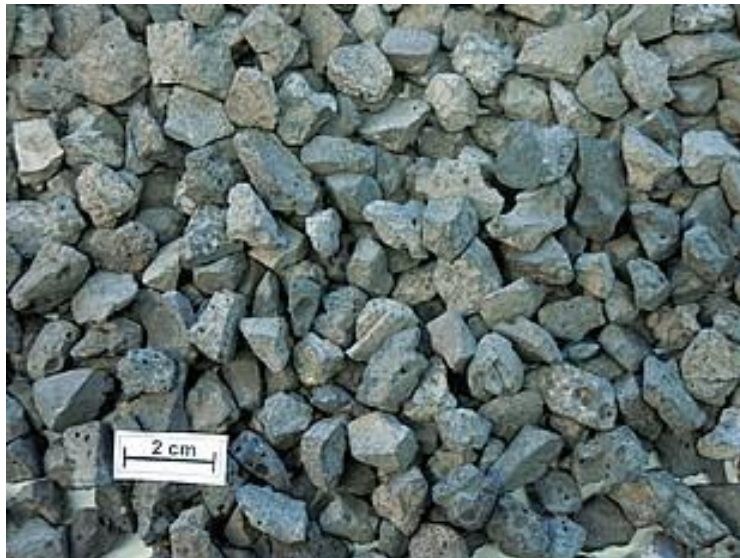
Slika 11. Krupniji primjerak troske iz kisikovog konvertora [21].
